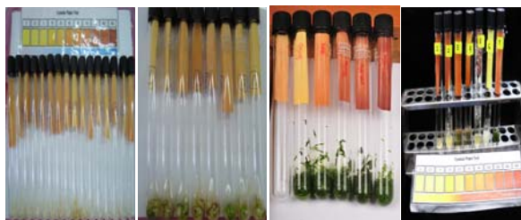
Gambar 7. Deteksi sianida pada bagian tanaman ubi kayu menggunakan cyanide/picrate paper test.
